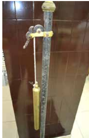
A la izquierda, garrucha, cuerda y plomada. A la derecha, detalle garrucha.
